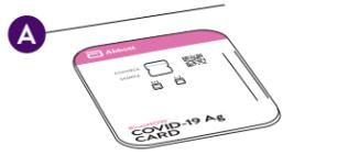
La tarjeta debe quedar en posición horizontal sobre la superficie de la mesa durante toda la prueba.
